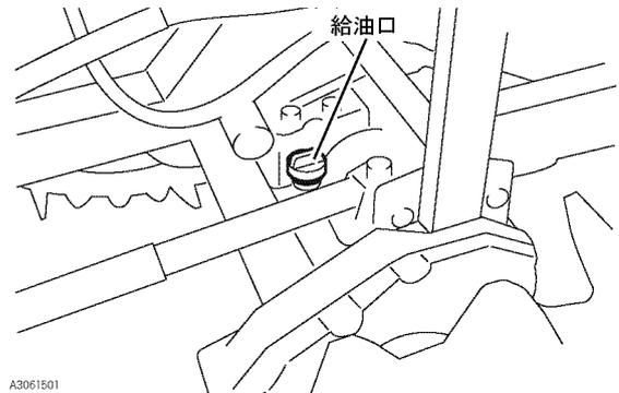
2. ジョーゴから規定量（検油ゲージの上限と下限の間）になるまで補給してください。
