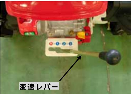
13 頁走行のしかたを参考に变速レバーを操作し、所要の变速
