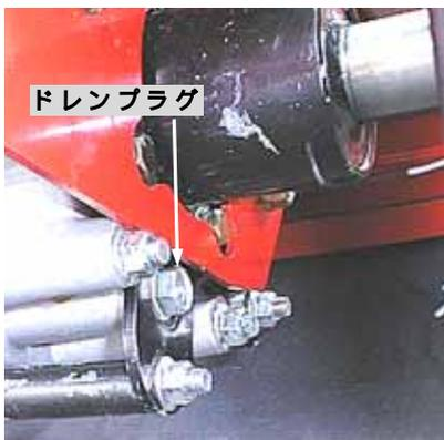
交換は、オイルを受け取る適当な容器を用意し、初回は20時間目、それ以降は100時間を目安にミッションケース右側面下部のドレンプラグ(排油栓)を外して行って下さい。
