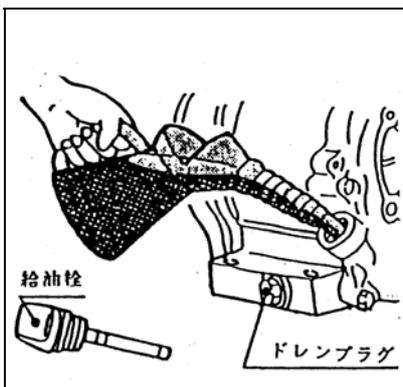
本機を水平な場所に停止させ、刈高さ調整でエンジンが水平になるように調整して下さい。
