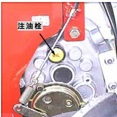
点検は、ミッションケース左側面上部の注油栓を外して確認して下さい。注油口を通してミッションオイルが目視で確認できれば(注油口いっぱいまで)ほぼ規定量のミッションオイルが入っています。
