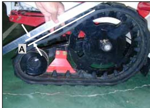
車体後部のクローラ張りボルトのロックナットを緩めて下さい。
