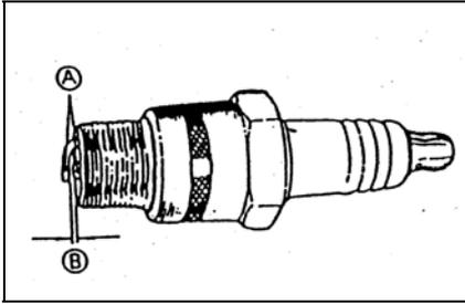
プラグレンチで点火プラグを外し、電極部分 A にカーボンが付着していたらワイヤブラシでこれを除去し、湿りがあればこれを拭き取って下さい。
