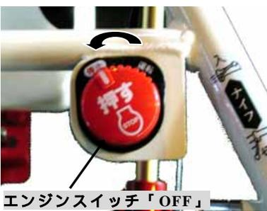
エンジンスイッチを「切(OFF)」位置にしてエンジンを停止して下さい。
