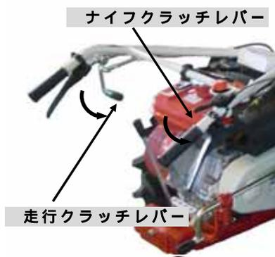
作業を停止する場合は、まず走行クラッチレバーを「切」位置にし、本機を停止させます。同時に駐車ブレーキが掛かります。
