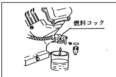
本機を 30 日以上使用しないときには、燃料変質による始動不良、又は運転不調にならないようドレンボルトを緩め、気化器内燃料を排出すると共に、燃料コックより燃料タンク内の燃料を抜き、湿気のない場所を選んで保管して下さい。エンジン及び本機の外面をオイルの染みた布で拭いて下さい。エンジンオイルを交換して下さい。
